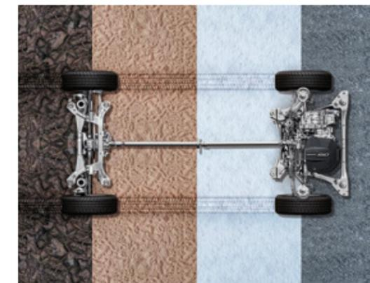
El control multiterreno garantiza que las tecnologías AWD, motor, transmisión y control electrónico de estabilidad puedan coordinarse para garantizar el agarre y la estabilidad en una variedad de superficies.
